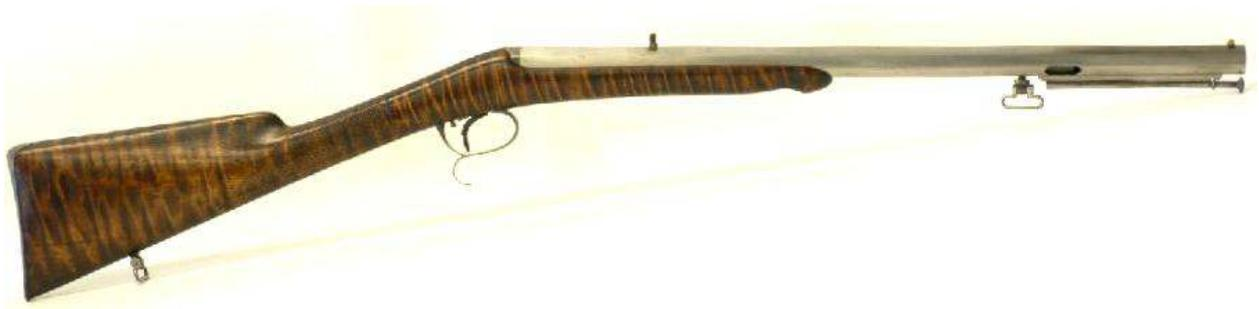
Von der technischen Seite her betrachtet ist ein Zimmerstutzen ein Gewehr mit gezogenem Lauf, der jedoch nur zwischen 15 und 30 Zentimeter lang ist. Dieser Lauf ist in ein Trägerrohr eingebracht, auf dem auch die vordere Visiereinrichtung befestigt ist.
